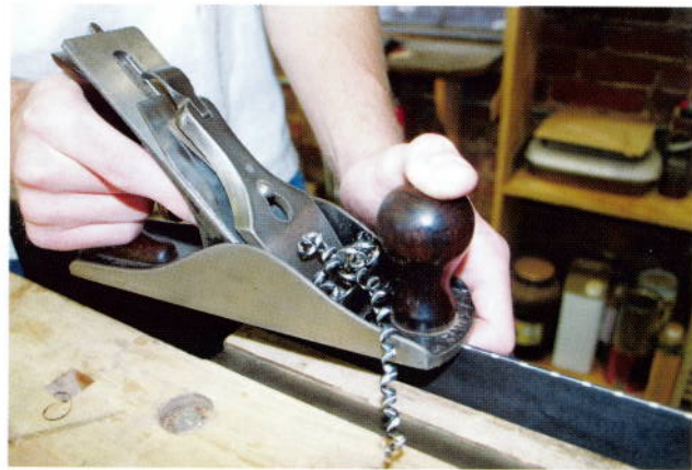
Fig. 19 Planing the edge straight
